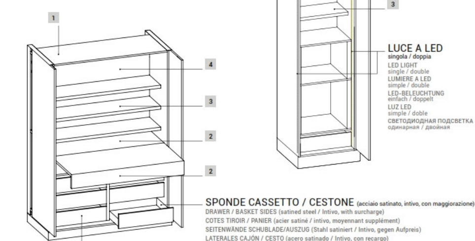
SPONDE CASSETTO / CESTONE (acciaio satinato, intivo, con maggiorazione) / COTES TIROIR / PANIER (acier satiné / intivo, moyennant supplément) / SEITENWÄNDE SCHUBLADE/AUSZUG (Stahl satiniert / Intivo, gegen Aufpreis) / LATERALES CAJÓN / CESTO (acero satinado / Intivo, con recargo) / БОКОВИНЫ ОБЫЧНОГО / ГЛУБОКОГО ЯЩИКА (сатинированная сталь / intivo, с наценкой)
